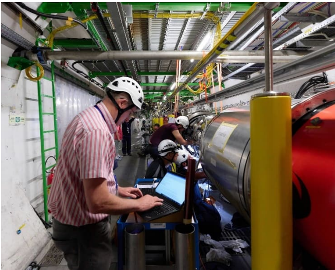
Paul Cruikshank, chef de l'équipe d'intervention sur le vide du LHC, avec son équipe, en train de démarrer le test de fuite sur le soufflet nouvellement installé.
